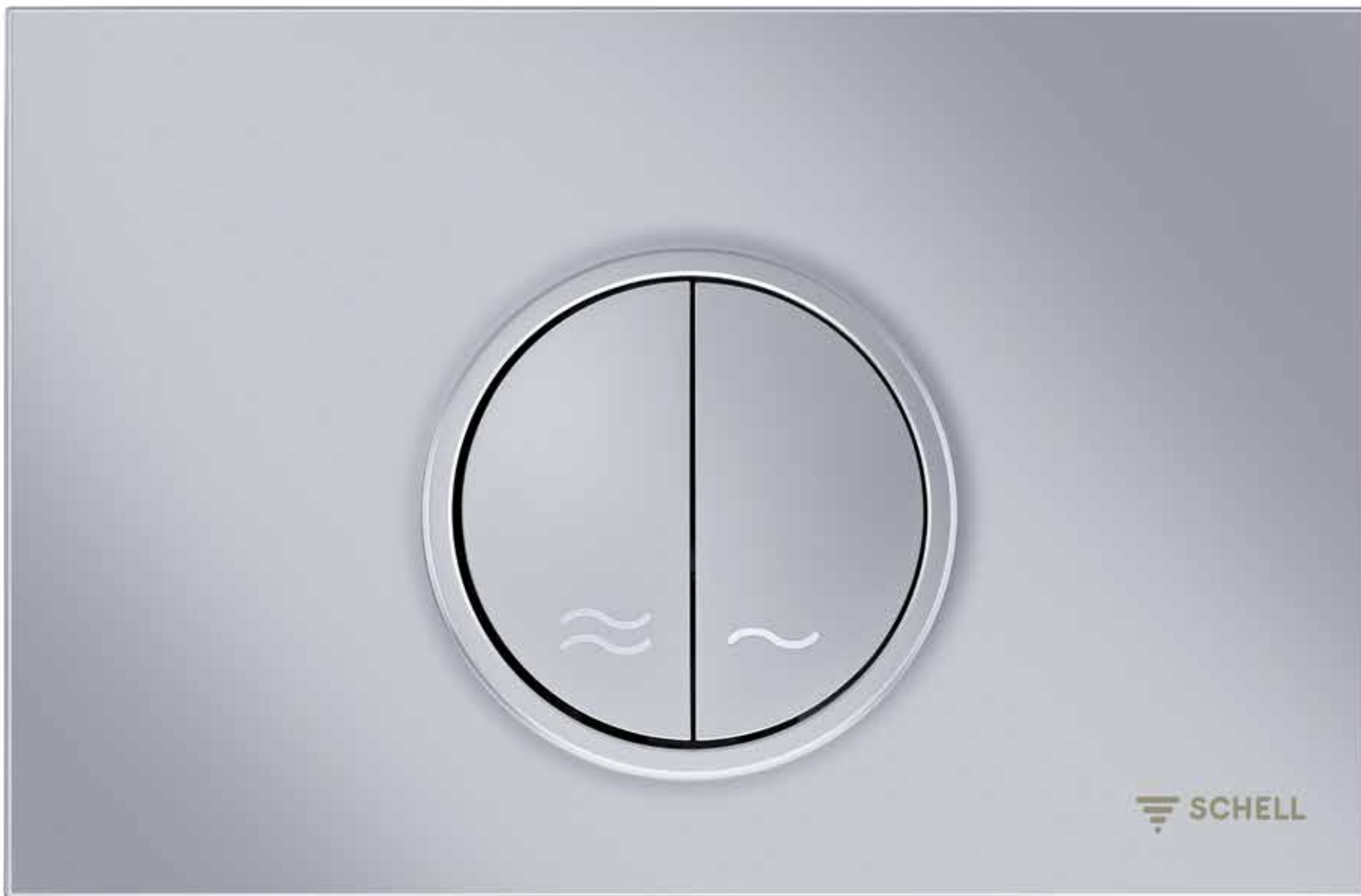
Placca di comando per WC MONTUS CIRCUM, risciacquo a due quantità 03 119 64 99, plastica (ABS), cromo opaco
