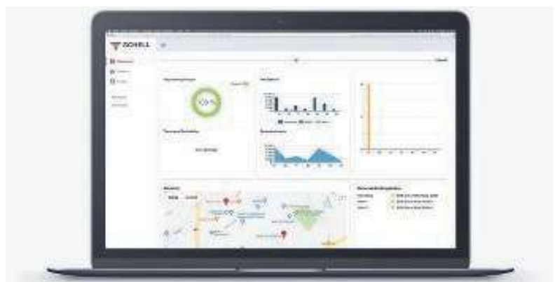
In der übersichtlichen Visualisierung von Smart.SWS werden Stagnationsspülungen mit Startzeit und Dauer aufgeführt sowie Temperaturverläufe dokumentiert.
