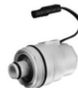
Electro válvula biestable de 6 V para la desinfección térmica con el sistema de gestión de agua SWS de SCHELL. La electro.válvula puede instalarse a posteriori en la conexión prevista del circuito de agua. Funcionamiento: El agua caliente se canaliza por fuera de la válvula termostática. El control se realiza mediante el extensor de bus SWS inalámbrico VITUS BE-FV.
