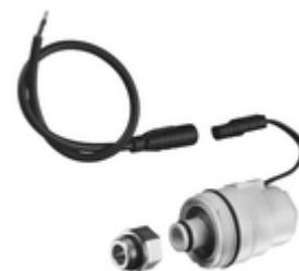
Electro válvula biestable de 6 V para la desinfección térmica con el sistema de gestión de agua SWS de SCHELL. La electro.válvula puede instalarse a posteriori en la conexión prevista del circuito de agua. Funcionamiento: El agua caliente se canaliza por fuera de la válvula termostática. El control se realiza mediante el cable extensor de bus SWS BE-K o mediante el extensor de bus SWS inalámbrico BE-F.
